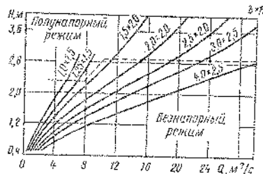
Рис. XIV.17. График для определения пропускной способности прямоугольных типовых труб. Цифры на кривых — отверстия труб, м
