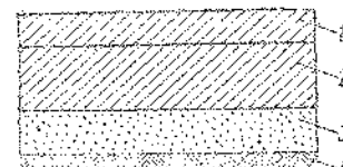
Рис. XIII.1. Конструктивные слои дорожной одежды: 1 — покрытие; 2 — основание; 3 — дополнительный слой основания; 4 — грунт земляного полотна
